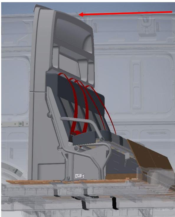
Glisser la mousse fournie entre le haut de la cloison et le pavillon du véhicule. Si besoin couper dans l'épaisseur pour ajuster en fonction du véhicule.
