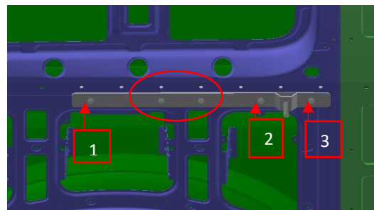
Figure N°9 perçages existants dans la caisse
