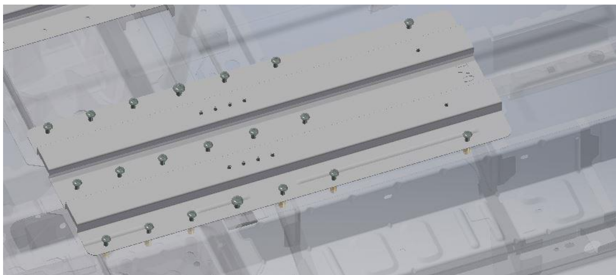
Figure 4 : Perçage du plancher à travers l'interface
