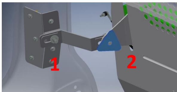
1. Dévisser et ôter l'écrou située sur la paroi du véhicule.
