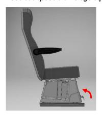
Agir sur la pédale située à l'avant du siège, la maintenir en position haute et faire glisser légèrement le siège pour aligner les pions insérés dans l'interface ou le rail avec les perçages.
